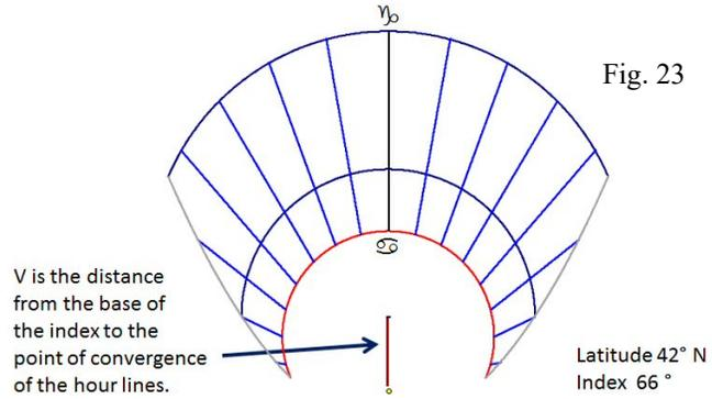
$$x_{\alpha} = r_{\delta} \sin t + r_{\delta} (\cos t \cos \varphi + \tan \delta \sin \varphi) \cot i_I \sin d_I$$
